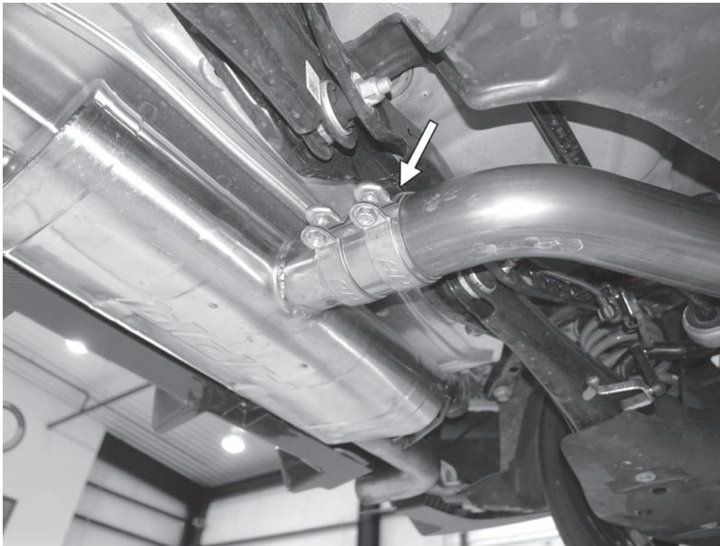
11) Verbinden Sie das hintere Ende des APR-Rohrbogens mit dem APR-Endschalldämpfer mit einer der mitgelieferten "Sleeve-Clamps". Die Schelle kann locker angezogen werden, muss aber noch richtig eingestellt werden.
